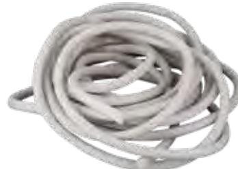
Izocam Peflex Fitil, ekstrüzyon yolu ile imal edilen polietilen esaslı dolgu fitilidir. Binaların derz ve dilatasyonlarında, ayrıca kapı ve pencerelerin duvar bireşimlerinde dolgu malzemesi olarak kullanılır.
