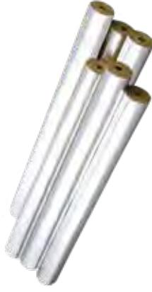
Alüminyum folyo kaplı yüksek birim ağırlıkta taşıyünününden imal edilen borular olup, 250°C'den yüksek sıcaklıklardaki sanayi borularının ısı yalitimında, boruların donmaya karşı yalitiminde ayrıca basınçlı su borularında titreşime ve sese karşı kullanılır.
